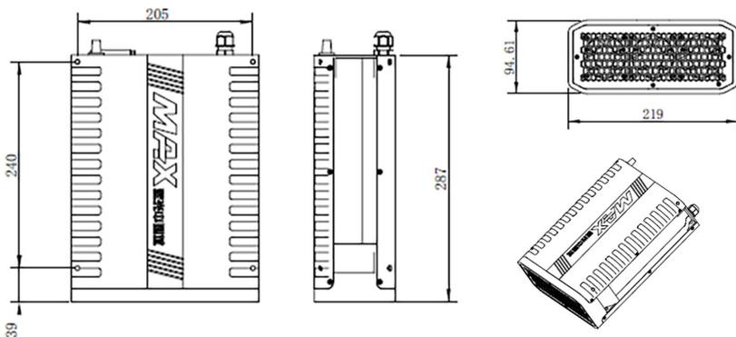
调 Q-5W-70W 激光器外观尺寸图 (单位: mm)
