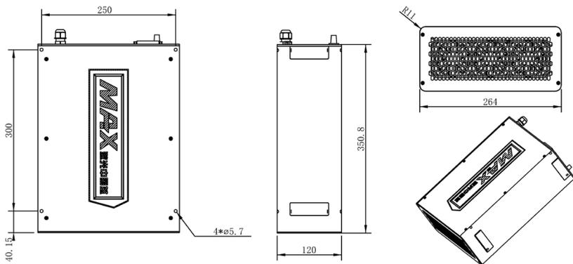
激光隔离器输出头尺寸如下图所示（单位：mm）
