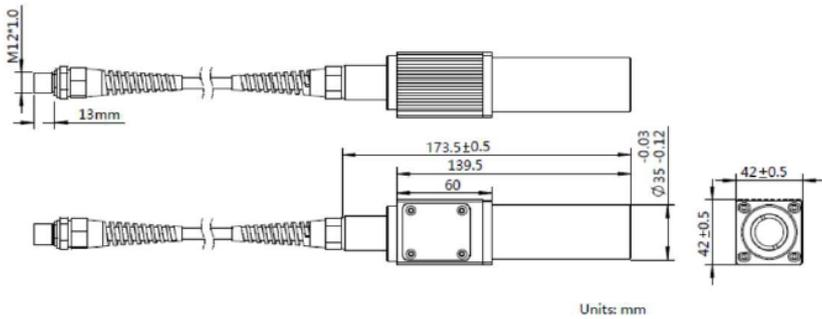
(MFPT-70) 激光器隔离器输出外观尺寸参考如下图所示 (单位: mm)
