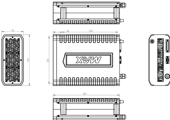
(MFPT-30~70) 激光器外观尺寸如下图所示 (单位: mm)
