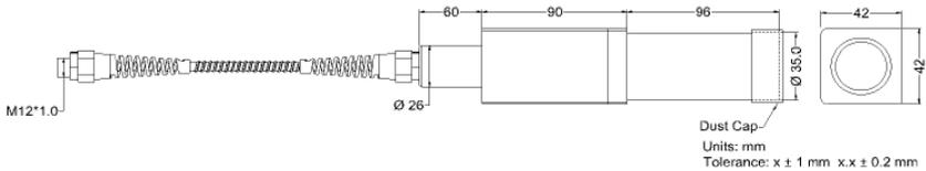
(MFPT-20) 激光器外观尺寸如下图所示 (单位: mm)
