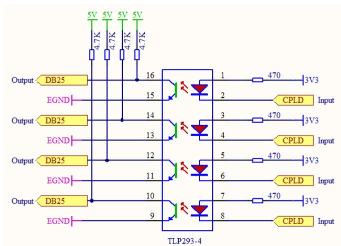
输出电路已经上拉，输出为 5 V(Pin 有 5 V 输入时)，输出最大驱动电流为 50 mA。
