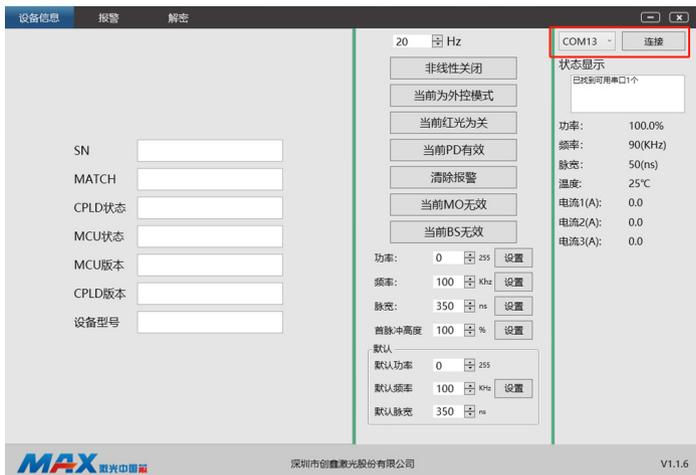
3. 上位机与激光器是通过串口连接，选择端口号，点击“连接”，进入如下界面，系统开启默认为外控模式。
