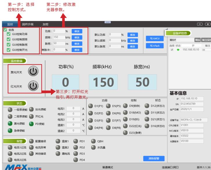
3.3 网口的1拖多功能显示及设置，监控多台设备时，可以随时切换设备，看设备状态。
