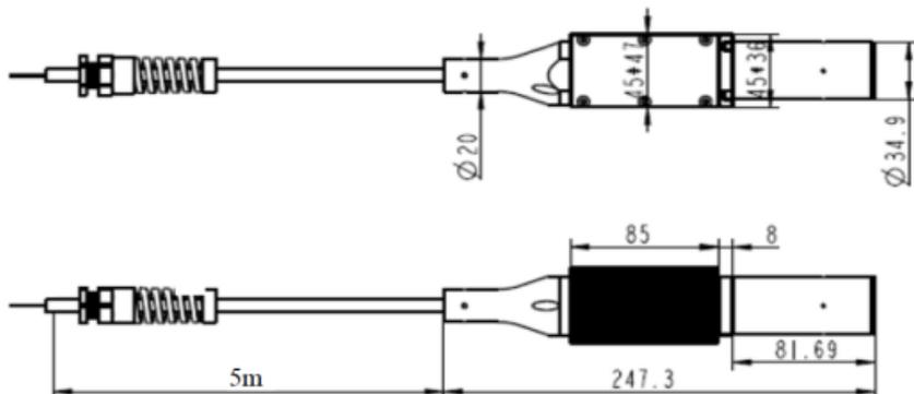
100~300M+ 脉冲光纤激光器整机外观尺寸如下图所示（单位：mm）
