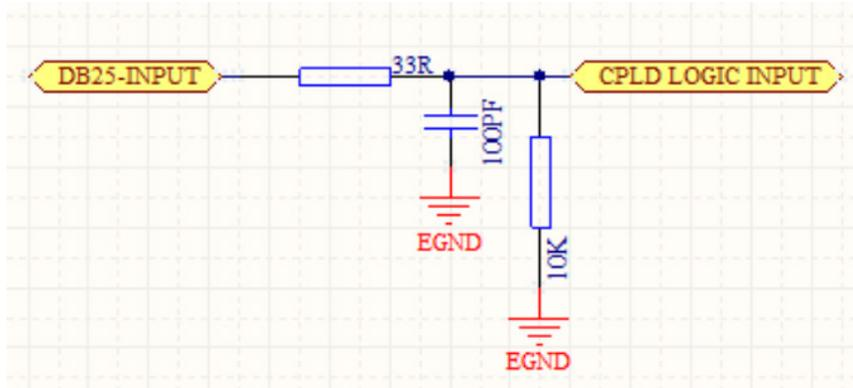
注：输入信号电压幅值需限制在  $5 \pm 2V$ ；
