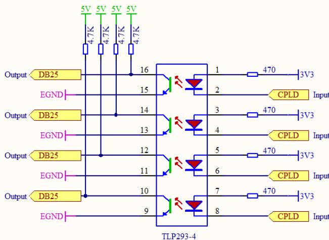
输出电路已经上拉，输出为 5 V(Pin 有 5 V 输入时)，输出最大驱动电流为 50 mA。
