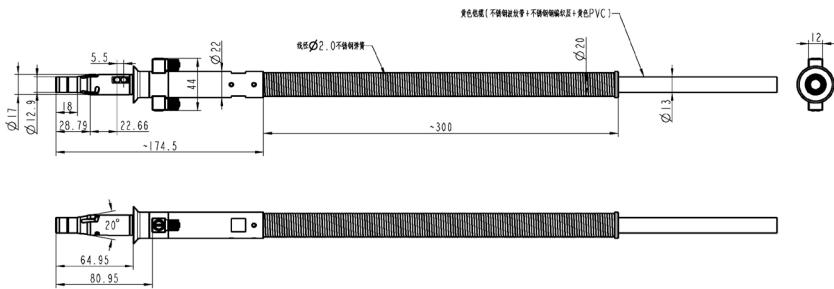
(MFPT-1000M) 激光器外观尺寸如下图所示 (单位: mm)
