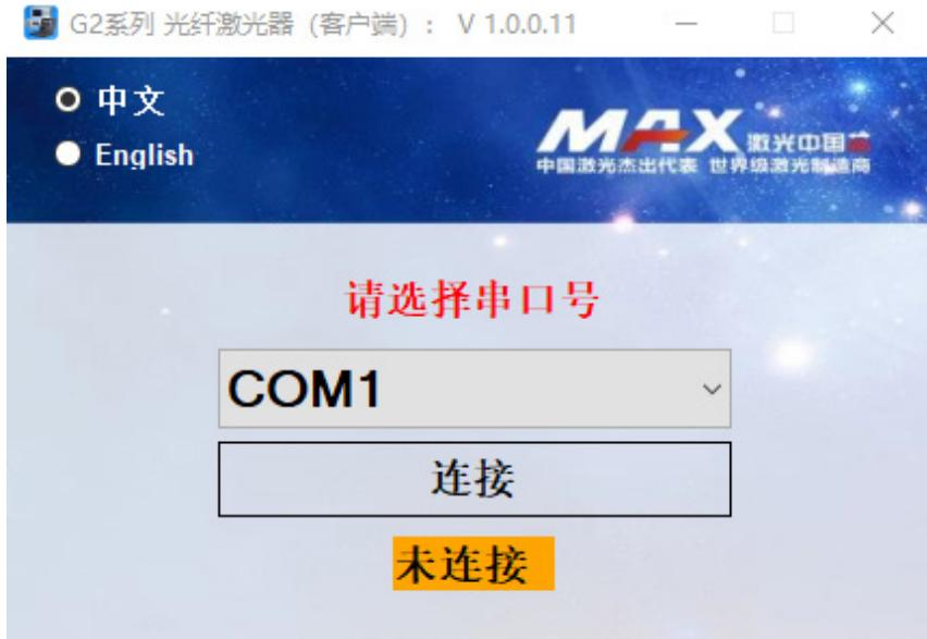
(6) 使用随机自带的串口连接线连接激光器和 PC 机，选择端口号，点击连接激光器，进入如下监控界面。
