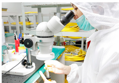
显微镜上安装光纤连接器
