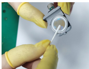
④ 用蘸酒精的无尘棉签或者无尘布轻擦保护镜片正面
