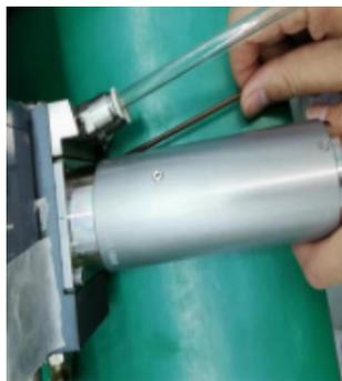
图 5-6 安装输出头
