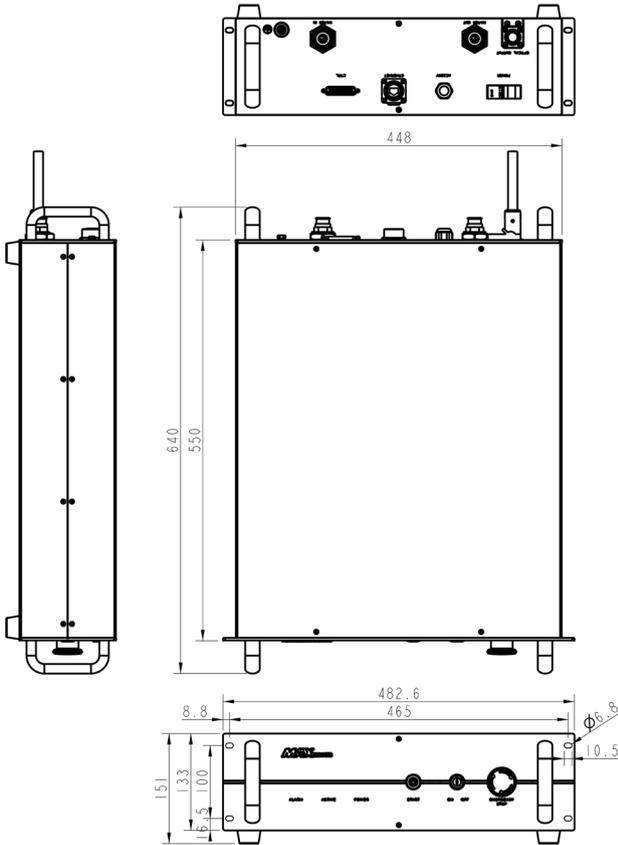
激光器输出端子外形尺寸图 (单位: mm)
