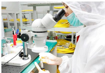
显微镜上安装光纤连接器
